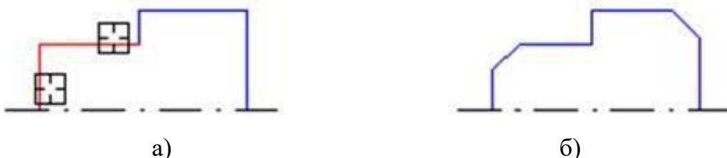
Рис. 1.20. Построение фаски: а) указание отрезков для построения фаски; б) исходное изображение фаски
